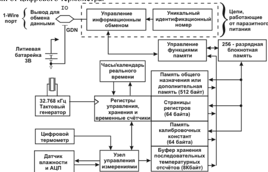
Структура устройства ГИГРОХРОН (DS1923)
