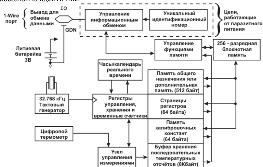
Структура температурных регистраторов DS1922L/T/E
