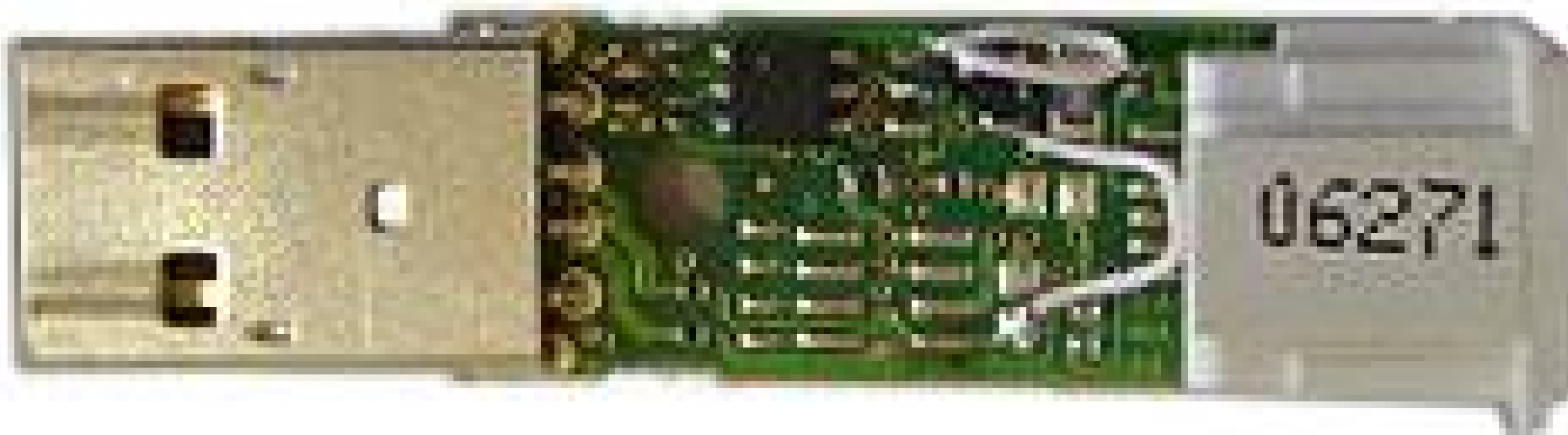
Фотографии размещения компонентов на плате адаптера типа ML94M для поддержки устройств с 1-Wire-интерфейсом через USB-порт персонального компьютера
