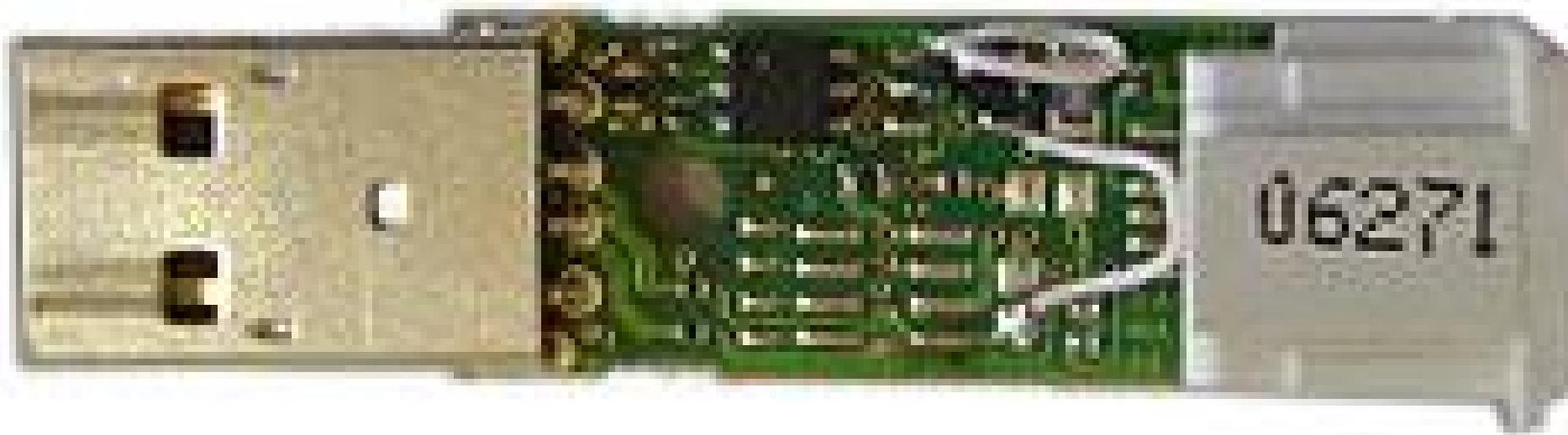
Фотографии размещения компонентов на плате адаптера типа ML94M для поддержки устройств iButton через USB-порт персонального компьютера
